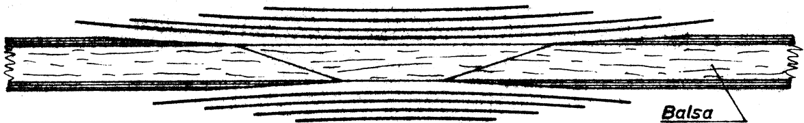
Bild 2: Reparatur der Klasse 2 (Innenseite zugänglich) Fig. 2: Repair of Class 2 (inside skin accessible)
